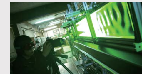
レーザー光線を用いてイルカ肌を模した微振動壁面を測定中
